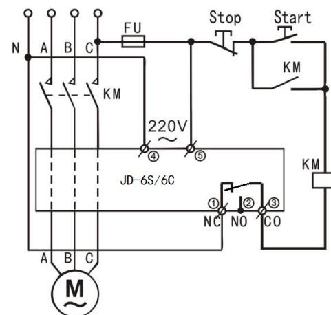
保护器在断电状态下，NC 与 CO 是通的。通电后，电动机工作正常时保持接通，当检测到电动机出现故障时，继电器断开，切断电动机电源。
