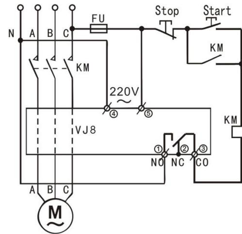
NO 为内部继电器常开点，NC 为常闭点，CO 为公共点。保护器在断电状态下，内部继电器是在释放状态，1、3 断，2、3 通。通电后，继电器立即吸合（如果启用了时间继电器功能，则延时吸合，见参数 F61），1、3 通，2、3 断，控制接通电动机电源。当检测到电动机出现故障时，继电器释放，断开电动机电源。
